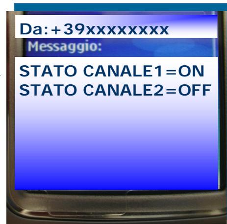
La ricezione del Messaggio SMS sul Vs. Cellulare Conferma l'Avvenuta Operazione con il controllo dello STATO dei CANALI .
